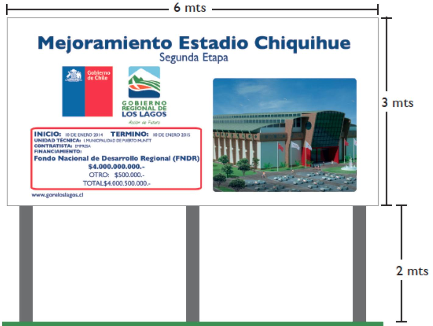
El soporte será una gigantografía, que sera de pvc, que estara en un soporte metálico de 30 x 30 x 2 mm. y en el área donde se fijara el letrero, éste deberá apoyarse en una superficie
